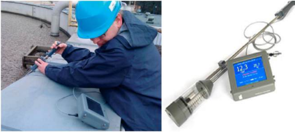
Şekil 5-8. Taşınabilir "Bioscope" respirometre (Głodniok, 2011)
