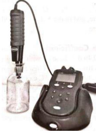
Şekil 5-1. BOİ tayininde kullanılan ÇO probu (Tchobanoglous vd., 2014)
