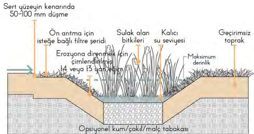
Tipik ıslak kanal (swale)
