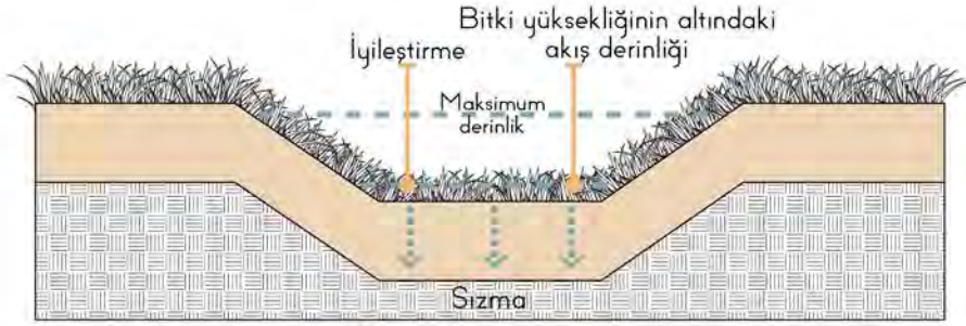
Tipik iletim/zayıflama kanalı (swale)
